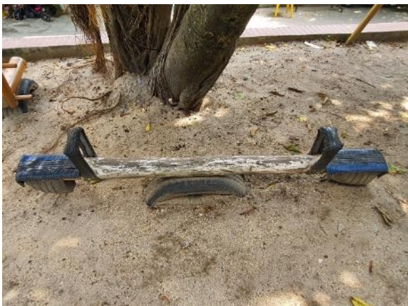
9-E : Module en matériaux recyclés dégradés
