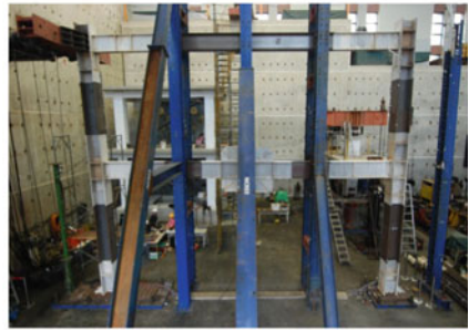
(d) MRF test (1.2% second floor drift)
