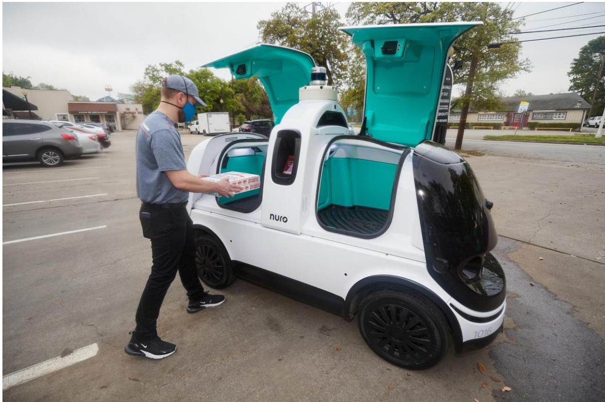
*Figura 16. Nuro es un prototipo autónomo de entrega de pizzas desarrollado para Domino's Pizza. Este vehículo actualmente se encuentra en funcionamiento de prueba para una tienda en Houston, Texas.*
