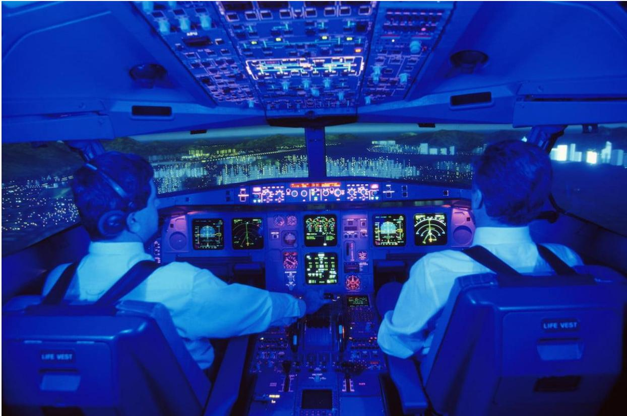
*Figura 8. Simulador de vuelos comerciales para capacitación de pilotos.
